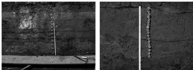
第33図 試料採取 (左) 20ccシリンダーによる泥質試料採取 (右) 5ccバイアルによる砂質試料採取
