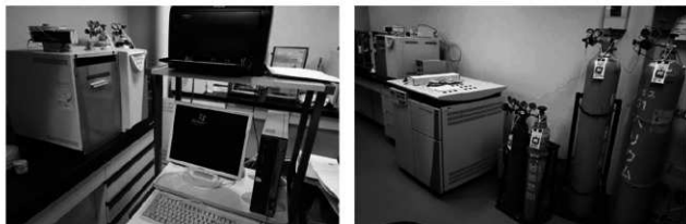
第35図 分析装置2 (左) CHN 元素分析装置 (サーモフィッシャーサイエンティフィック社 Flash2000) (右) 元素分析装置 (サーモフィッシャーサイエンティフィック社 Flash EA 1112) と質量分析装置 (Delta V. Advantage) の組合せによる安定炭素同位体測定装置
