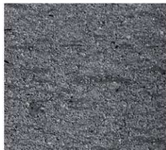
図19 石造物にみるユータキシティック構造 本図は、藤井大祐2017「鹿児島市埋蔵文化財発掘調査報告書(80)薩摩藩主島津家墓所(福昌寺跡)調査報告書」より転載したものである。
