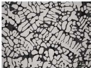
Photo.3 炉壁、碗形鋳冶滓の顕微鏡組織
