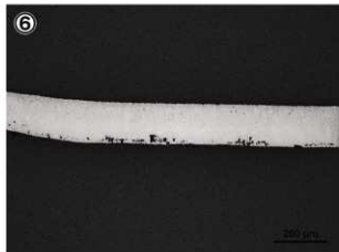
Photo.9 鍛造剥片の顕微鏡組織
