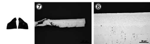
Photo 8 粒状滓、鍛造剥片の顕微鏡組織
