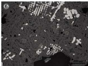
Photo. 4 鍛冶滓の顕微鏡組織
