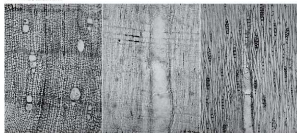
横断面 0.1mm 放射断面 0.1mm 接線断面 0.1mm クスノキ科 (IVKISR1:22)
