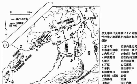
第13図 大阪平野周辺の活断層と伏見地震による可能性が高い地震跡を検出した遺跡
