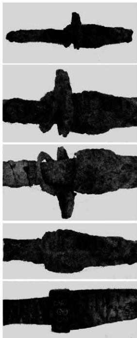
挿図16 鍮・象嵌の表出工程 (処理前→途中→処理後)
