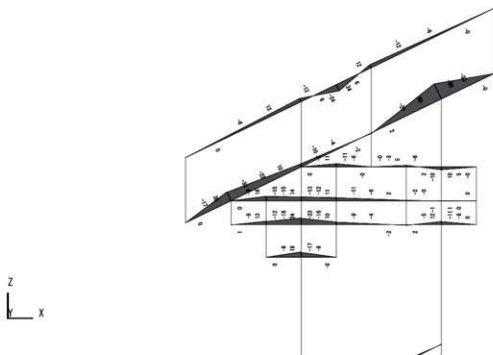
Y04 (応力図：長期) 六重尾垂木 (平) および肘木 セン断力図 単位：kN
