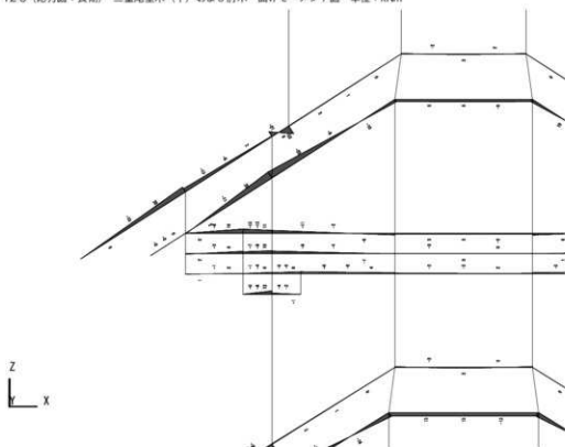
Y2-3 (応力図:長期) 三重尾垂木 (平) および肘木 セン断力図 単位: kN
