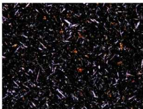
緑色岩製磨製石斧の顕微鏡写真 (前川2007 針状のアクチノ閃石が特徴的)
