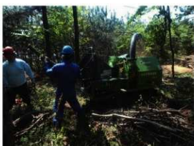
写真 35 移動式チップパーによる枝条の現場破砕
