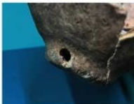
18 挿入口の工具痕
