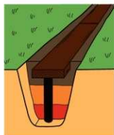
第194図 土台と基礎杭の模式図
