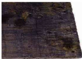
内面の変色した部分の拡大
