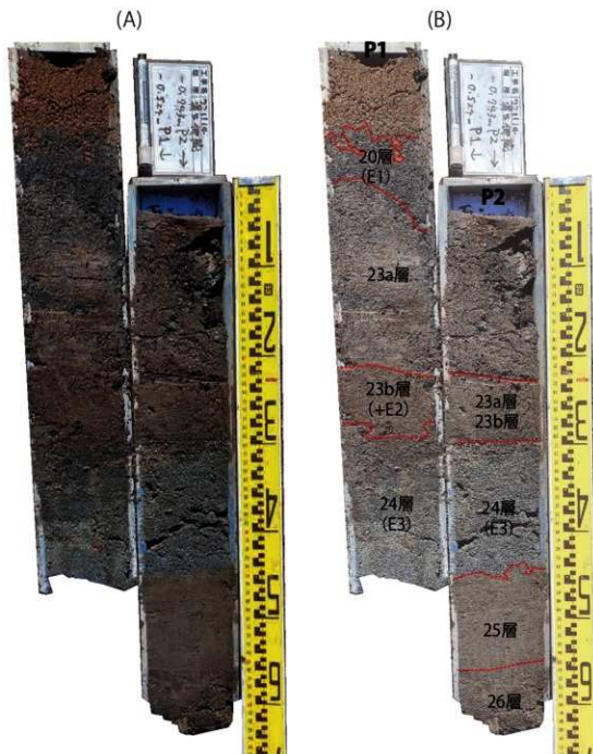
第178図 ジオスライサーNo.1(P1)およびNo.2(P2)の試料採取状況
