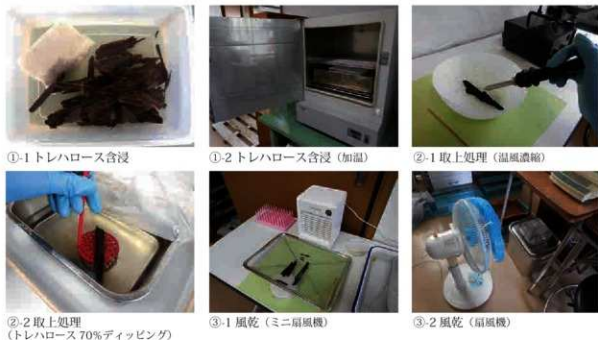
第184図 トレハロース含浸処理法の基本的な処理工程
