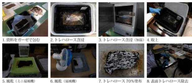
第 185 図 実験 2 トレハロース含浸処理法処理工程
