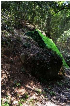
径 2 m を超える花崗岩円礫 ( 周囲の真砂土が流出することで転がり出す可能性有り )
