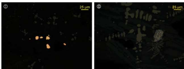
洋部および微小金属粒の反射電子像 (COMP: ③・④) および特性X線像
