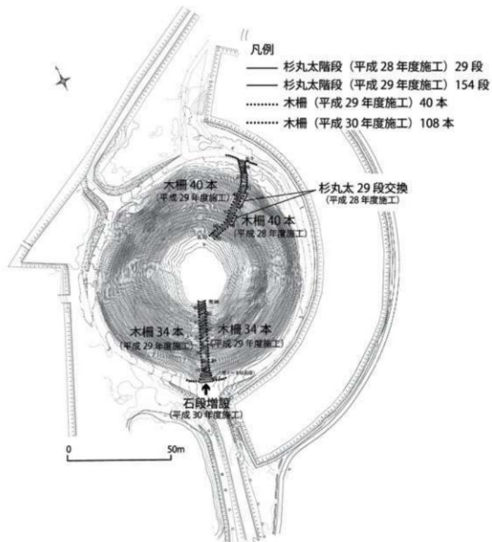
図2 丸墓山古墳安全対策工事 年度別施工箇所
