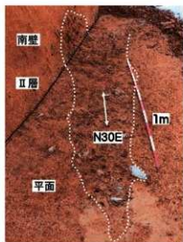
第11図 噴礫脈の平面形態と断面形態
