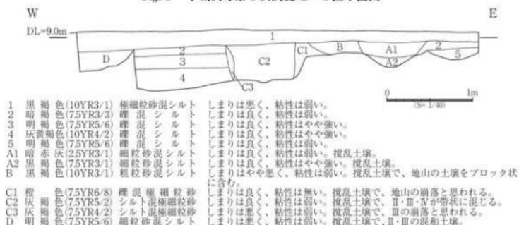
Fig. 6 平城貝塚第8次調査VII-1区南壁土壤堆積図
