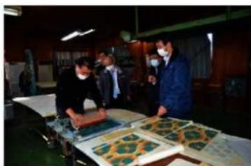
主組76 2階西平4室天井紙（模様印刷洋紙）試作状況
