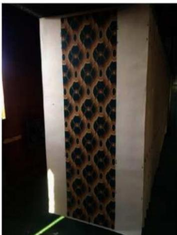
主組78 2階西平4室天井紙（模様印刷洋紙）シルクスクリーン印刷乾燥状況
