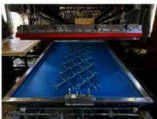
主組77 2階西平4室天井紙（模様印刷洋紙）シルクスクリーン印刷状況
