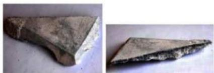
写真4-4-4-23 ミセ西面擬石塗 当初仕上げ片
