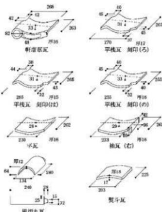
図4-4-3-3 「キ沢」の刻印がある瓦寸法
