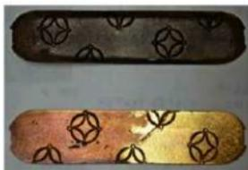
写真3-2-11-1 引手金具酸洗い試験施工
