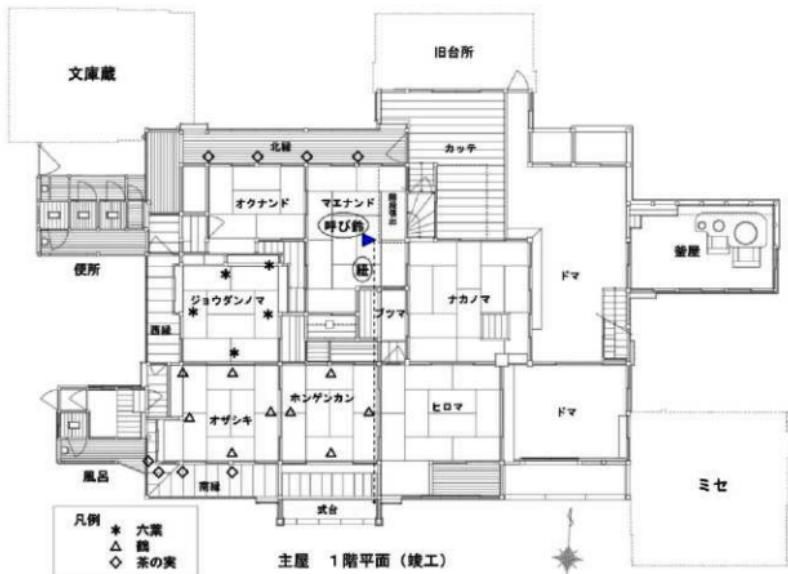
図 4-4-8-1 長押金具配置図(竣工)
