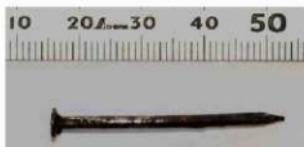
写真 4-4-2-3 明治 15 年頃丸釘（時代 A）拡大
