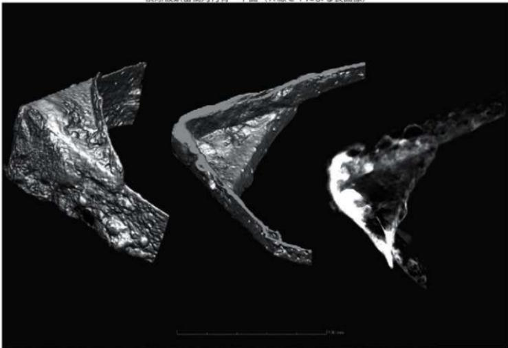
衝角底板の形状（X線CTによる表面像、透視像）
