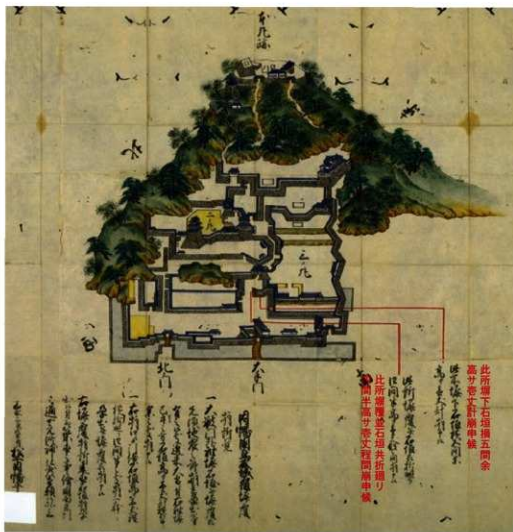
①鳥取城修覆願絵図(嘉永3年(1850)) 石垣の崩壊状況を記す
