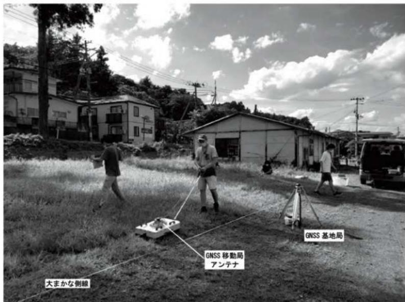
①.RTK-GNSS 測位を併用した地中レーダ計測
