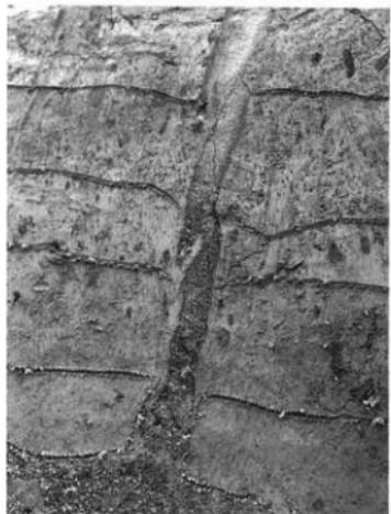
写真 7 砂脈 b と液状化跡の断面形
