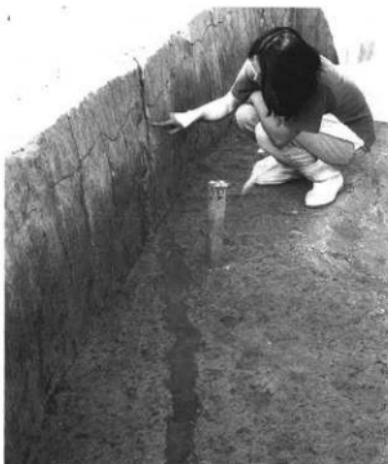
写真11 砂脈 c の平面形
