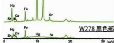
第7図 飾弓のED-XRFによるスペクトル
