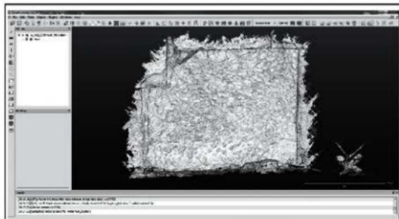
※①のCloudCompareは、オープンソースのソフトウェアで、HPからダウンロードできる。画面上の操作で、任意の方向・縮尺で閲覧ができる。表示方法も多様である。それ以外にも点群の編集や計測等の分析作業も可能である
