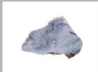
11 玉髓質泥岩原石001 1000°C 2h
