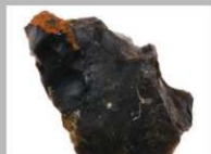
3 玉髓質泥岩原石001 200°C 2h
