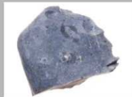
10 玉髓質泥岩原石001 900°C 2h
