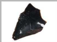
5 玉髓質泥岩原石001 400°C 2h
