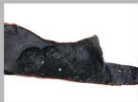
6 玉髓質泥岩原石001 500°C 2h
