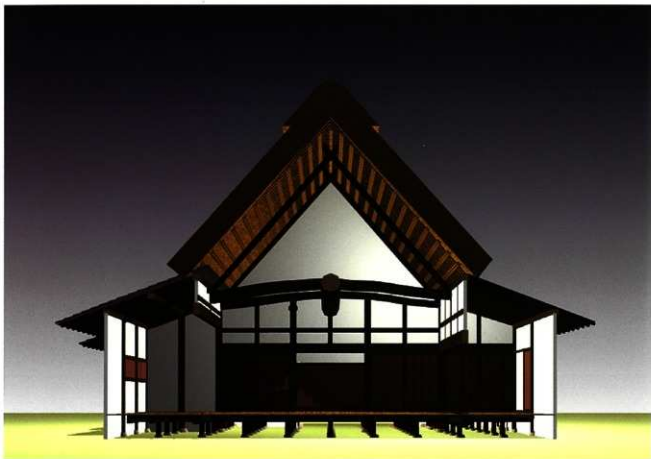
↓江戸後期の藤瀬家住宅 横断面透視図（カンジョウバ、イマ、ダイドコロ）
