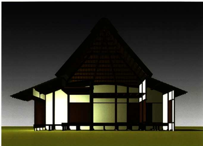
↑江戸後期の藤瀬家住宅 横断面透視図（オゲンカン、オヘヤ）
