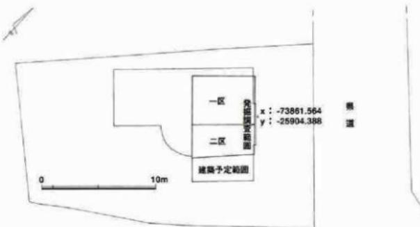
図4 調査範囲と測量基準点設定図
