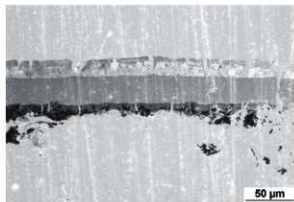
写真16 No. 5外面（黄色部）の断面写真
