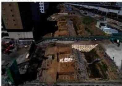
◀京浜東北線橋脚と築堤(B・C区) 南北方向に連続する四角い穴が、高輪ゲートウェイ駅開業まで使用された京浜東北線の乗り越し橋の跡。線路は当初の築堤の位置を踏襲していることが分かる。
