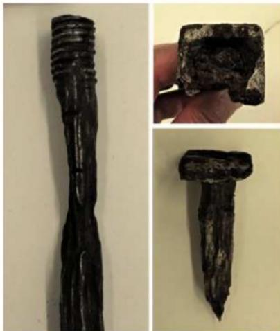
**ボルト状金具** 海(東)側の石垣の基礎構造である留め杭と鋼木、控木と控杭の固定には、この金具が使われている。ネジきりされたボルトの頭部(写真左)に、四角いナットを接続させて使用していた(写真右)。いずれも当時の日本にはないものであり、輸入されたものと考えられる。調査時には採取も難しいほど、腐食が進んでいた。
