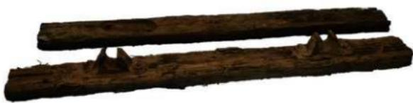
▲チャー(座鉄)付き枕木 長さ2.3 mの枕木に2個のチャーと呼ばれるレールを固定する金具が付いている(下)。チャーの表面全体と枕木との接着箇所に接着剤?が塗布されている。チャーは枕木をチャーの形に彫り込んで設置されていることが分かる(上)。4-A区の3線化(明治32年)の覆土内から出土した。
