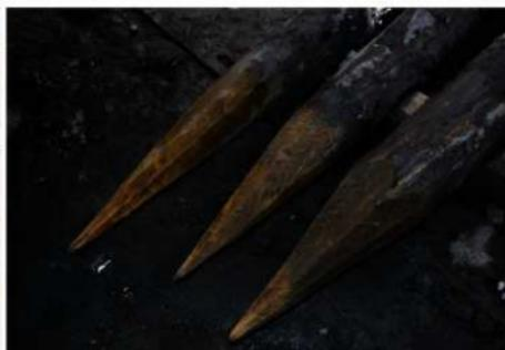
▲築堤を支えた杭 留杭や控杭など、築堤の荷重を直接的に支えていた杭は、基盤層まで確実に打ち込めるよう、先端が6~8面と丁寧に加工され、鋭い鉛筆のように先を尖らせていた。
