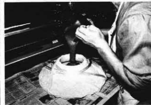
6 凹型へ合成樹脂を流し込む
