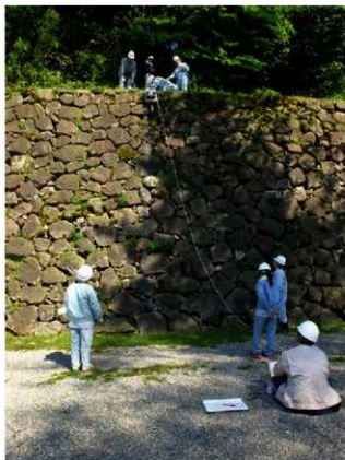
第 82 図 GPR 探査作業風景
