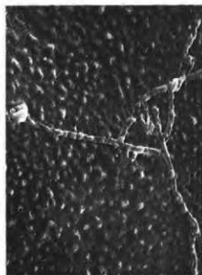
1 モミ属炭化材の環道管中の菌糸(×11,450)
