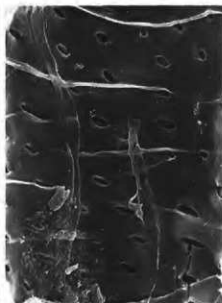
2 サクラ属炭化材の道管中の菌糸(×2,820)
