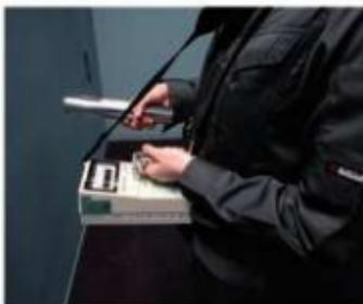
空間線量は変化しますので、定期的に、同じ条件、位置で継続して測定する必要があります。測定する場所の見取り図や地図を用意し、どの地点で測定した値かがわかるように印と記録を付けます。地面や床などにも印を付けられる場合は、付けておくとよいでしょう。
