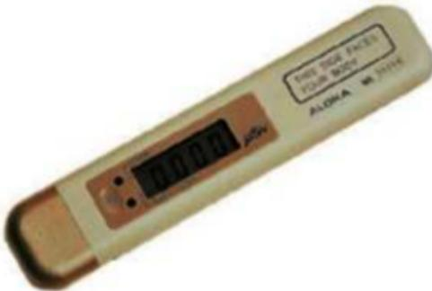
個人が受けた放射線量をその場で確認できるのがポケット線量計です。電源を切るまで、数値が積算されます。男性は胸部、女性は腹部に液晶表示面を体側に向かって装着します。携帯電話等、電子機器類の発する電波に反応するので同じポケットに入れず20cm以上、離して使用します。
