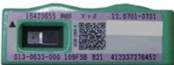
ガラスバッジは特定の個人専用で使うものですので、一人一人の被ばく線量を測定する装置として有効です。
