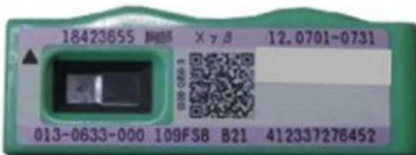
ガラスバッジは特定の個人専用で使うものですので、一人一人の積算被ばく線量を測定する装置として有効です。
