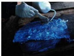
写真34 SNB-05による強化処理
