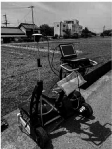
図174 廉価な高精度GNSSと地中レーダー探査機器との連動
