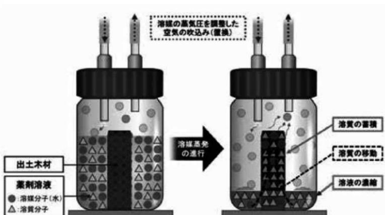
図146 溶媒蒸発を利用した新たな薬剤含浸法の模式図
