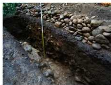
① 北ルート 予備1次1トレンチ 上壁と考えられるカマボコ状の盛土が確認された。
