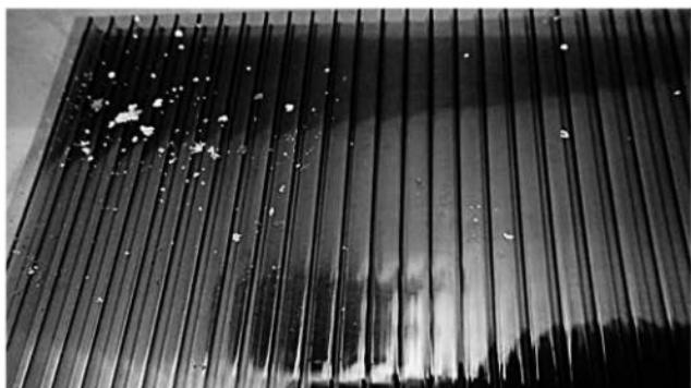
図2 ポリカーボネート板上の微小剥落片
