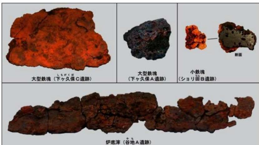
析しました。箱型炉と豊型炉により、鉄の種類のはっきりとした違いはみられませんでした。ただし、豊型炉ではやや炭素量の多い鉄が多い傾向が読み取れます。平安時代に高炭素鋼<sup>こうたんそくこう</sup>や銑鉄<sup>さんてつ</sup>が生産可能であったことが分かります。
