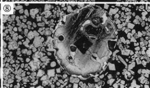
IV-2-写真3 埴埴(トリベ) 付着物の顕微鏡組織(3)
