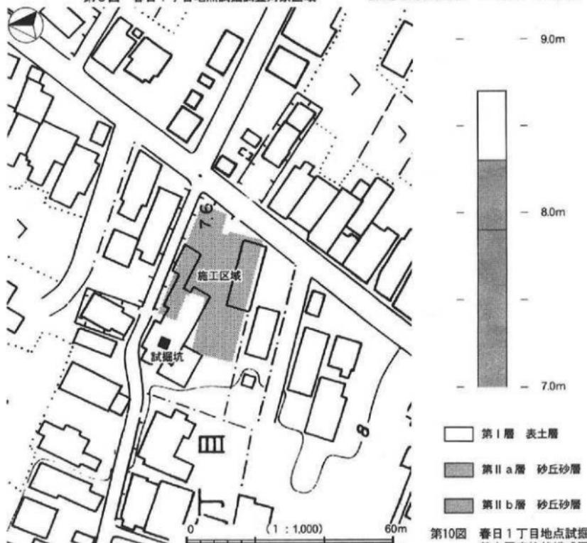
第9図 春日1丁目地点試掘調査試掘坑配置図
