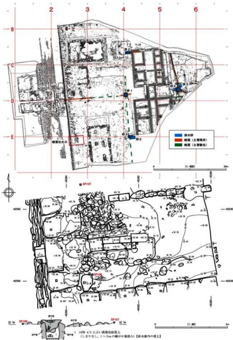
第 30 図 近代暗渠全体図 (S=1/400)、暗渠吐水口 (近代転用) 平面図 (S=1/40)
