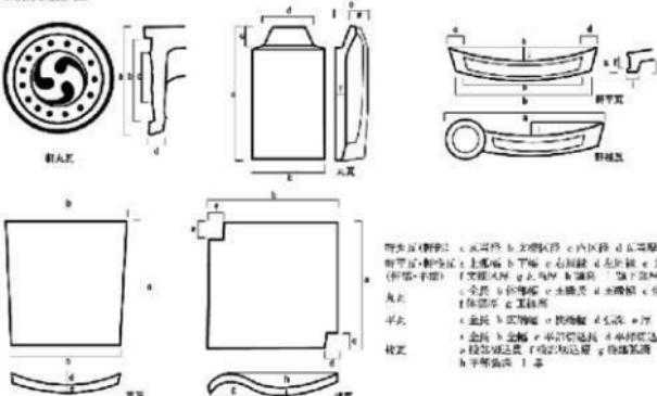
図表2(計測部) a:本高径 b:文理幅径 c:内径 d:本高厚
