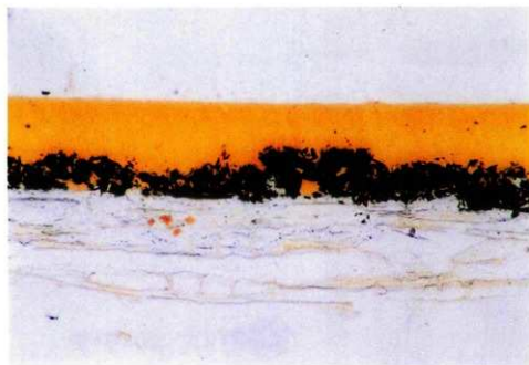
写真8 透過光下での塗膜断面 (×400)
