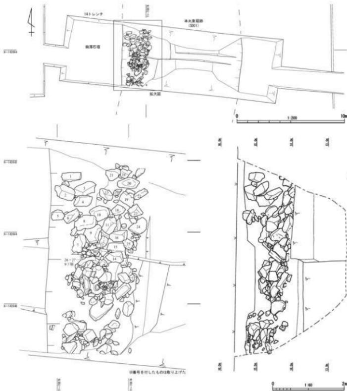
Fig.29 本丸東石垣崩落痕跡詳細図
