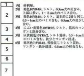
Fig.17 2002-P 土層柱状図
