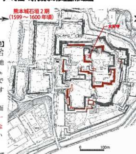
赤色網掛け部分は平成28年熊本地震で石垣が崩壊した箇所すべて江戸時代以降の修理箇所と想定
